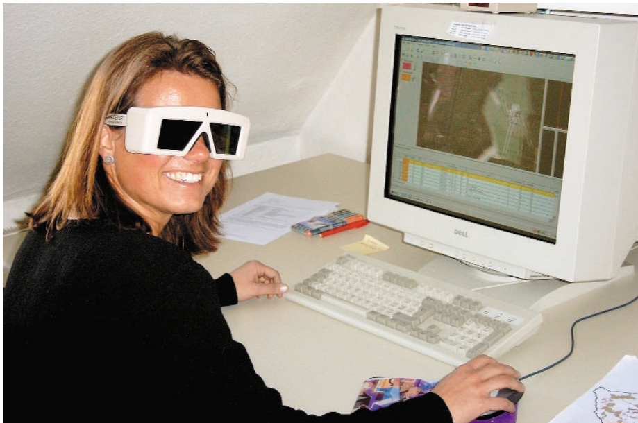
Fig. 4: Arbeitsplatz für digitale Photogrammetrie. Mit der Spezialbrille können Stereo-Luftbilder betrachtet und interpretiert werden.
